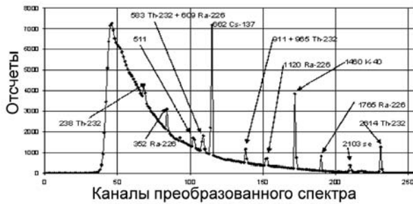
Рис.11 Измерения (полет) над территорией со значительным загрязнением радионуклидом ^{137}\text{Cs} и обычным радионуклидным составом грунта. Исходный (аппаратурный) и преобразованный спектры.
