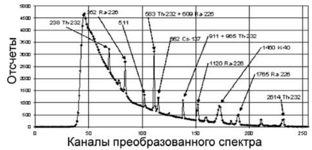
Рис.12 Измерения (полет) над территорией с небольшим загрязнением радионуклидом ^{137}\text{Cs} и обычным радионуклидным составом грунта. Исходный (аппаратурный) и преобразованный спектры.
